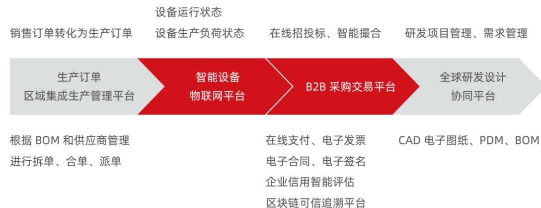
来自终端门店或视频直播 KOL 网红的订单，在区域集成生产管理平台上，根据全球研发设计协同平台上的 PDM 和 BOM，根据供应链平台上的可信供应商信息，进行生产订单的拆单、派单、合单。
